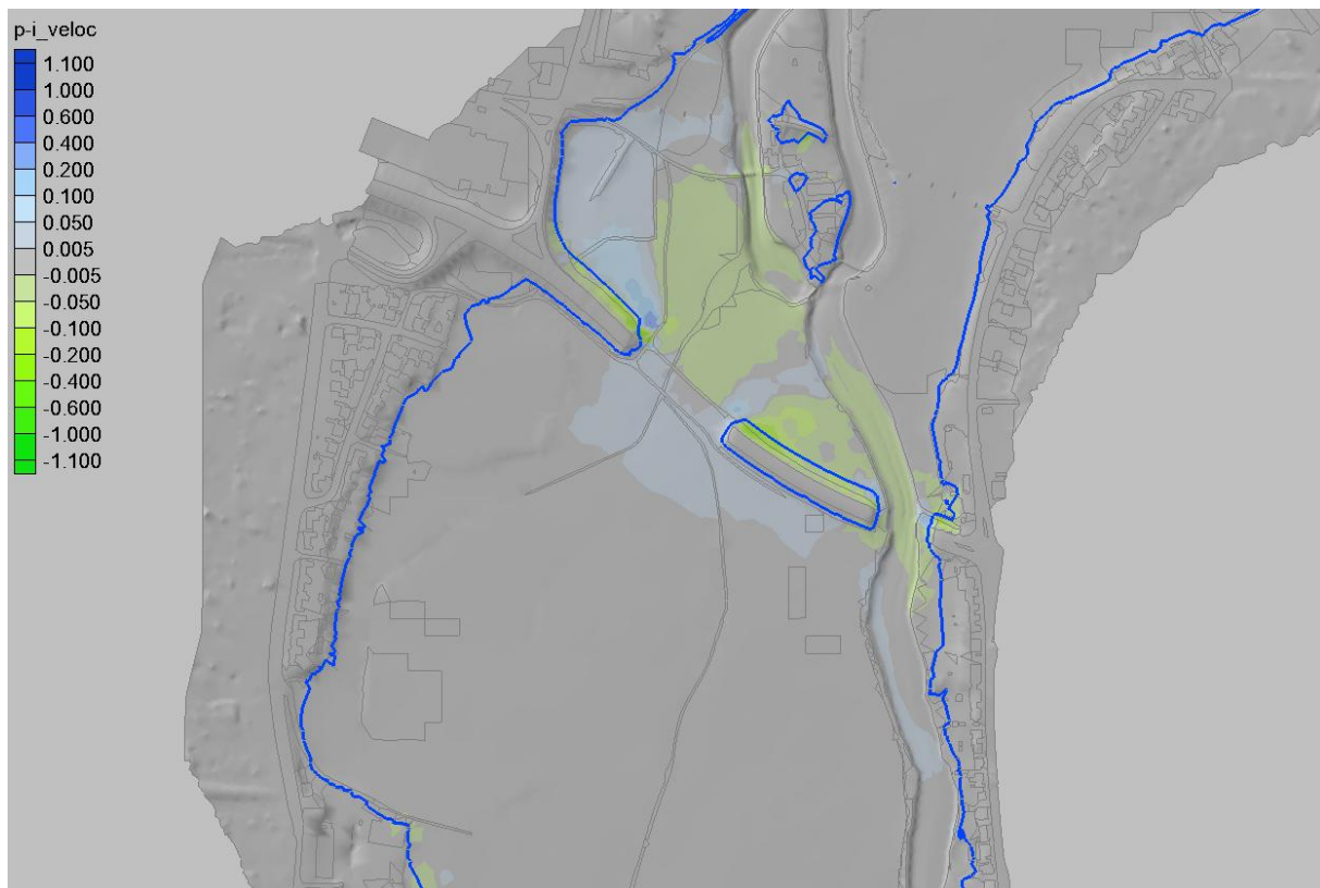
Abbildung 5-1: Differenz der Fließgeschwindigkeiten Planzustand minus Istzustand [m/s]
