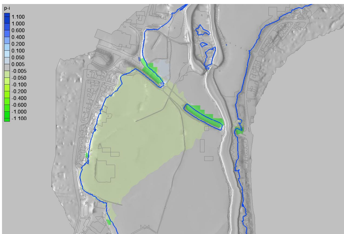
Abbildung 5-2: Differenz der Wasserspiegellagen Planzustand minus Referenzzustand [in m]
