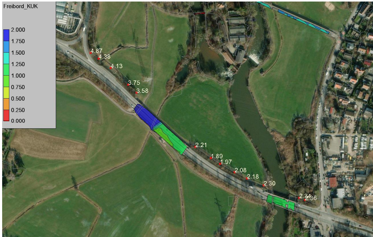
Abbildung 5-3: WSPL minus Höhe Konstruktionsunterkante im Modell; zzgl. Freibord StUB-OK
