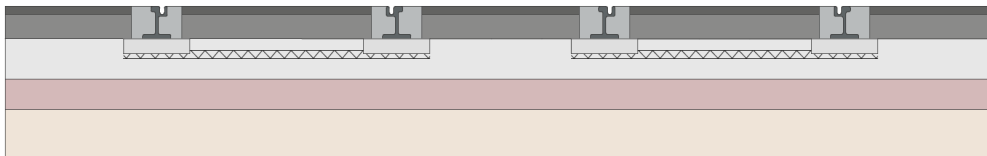
Abb. 27: Prinzipskizze Querschnitt straßenbündiger Bahnkörper mit dunkler Deckschicht
