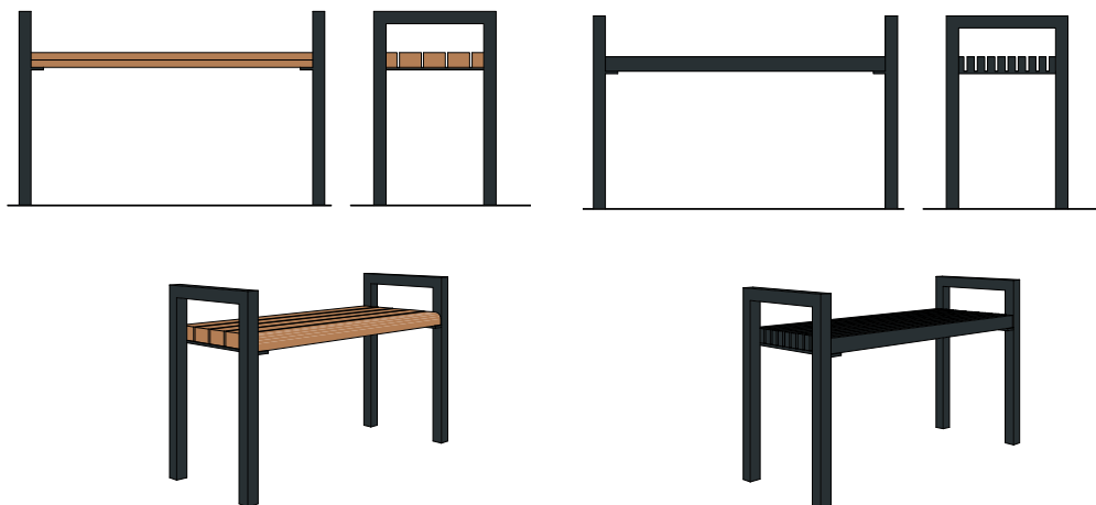
Abb. 85: Grundform 1 - Bank zur Anwendung im FGU mit Holz-Lattung bzw. Metall-Leisten
