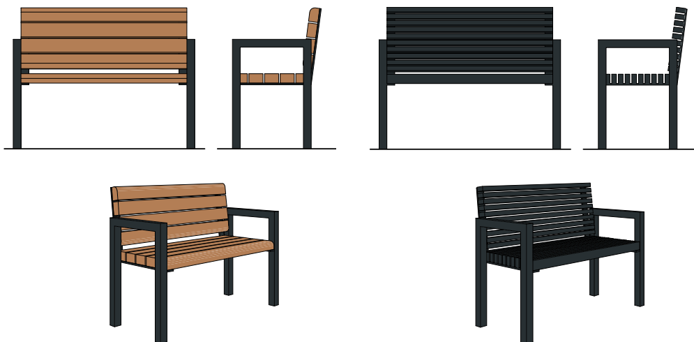
Abb. 86: Grundform 2 - Bank zur Anwendung auf dem Bahnsteig mit Holz-Lattung bzw. Metall-Leisten
