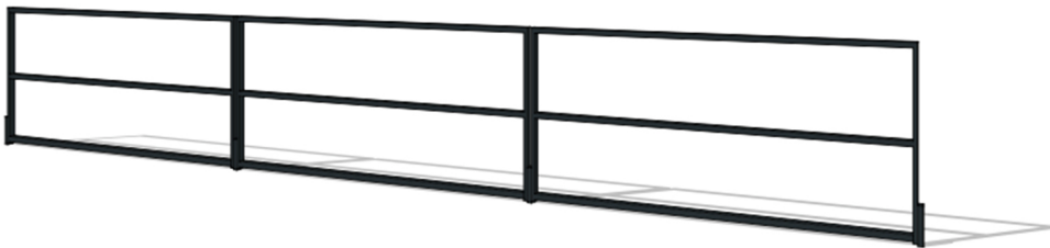
Abb. 80: Geländer aus Flachstahl-Pfosten und Vierkant-Rohrstreben mit Tastleiste am Boden
